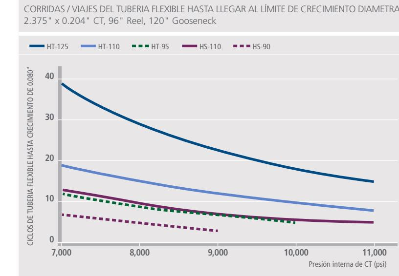
Una comparación del crecimiento diametral (ballooning) para los grados de tecnología BlueCoil® frente a los grados HS-110 y HS-90 convencionales.
