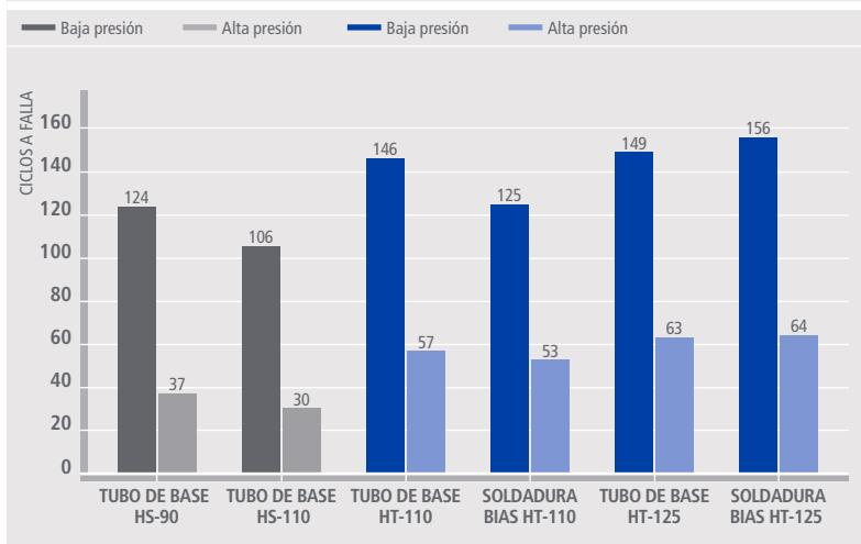
tubo base como en las soldaduras al bies. En las tuberías flexibles convencionales, las soldaduras al bies típicamente fallan mucho antes que el tubo base en ambientes agrios, incluso para los grados de menor resistencia.
