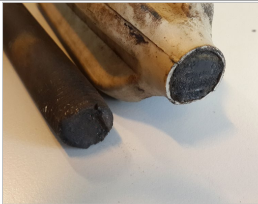
Guide bottom edge failure
